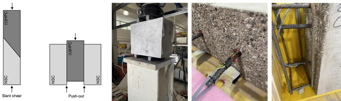
**Abbildung 12: Probekörperformen und Push-Out Tests inkl. Bewehrung**
